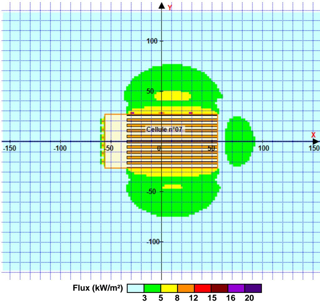
Pour information : Dans l'environnement proche de la flamme, le transfert convectif de chaleur ne peut être négligé. Il est donc préconisé pour de faibles distances d'effets comprises entre 1 et 5 m de retenir une distance d'effets de 5 m et pour celles comprises entre 6 m et 10 m de retenir 10 m.
