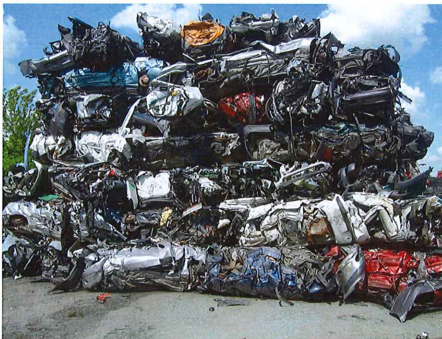
Stockage des carcasses de « VHU » après écrasement
