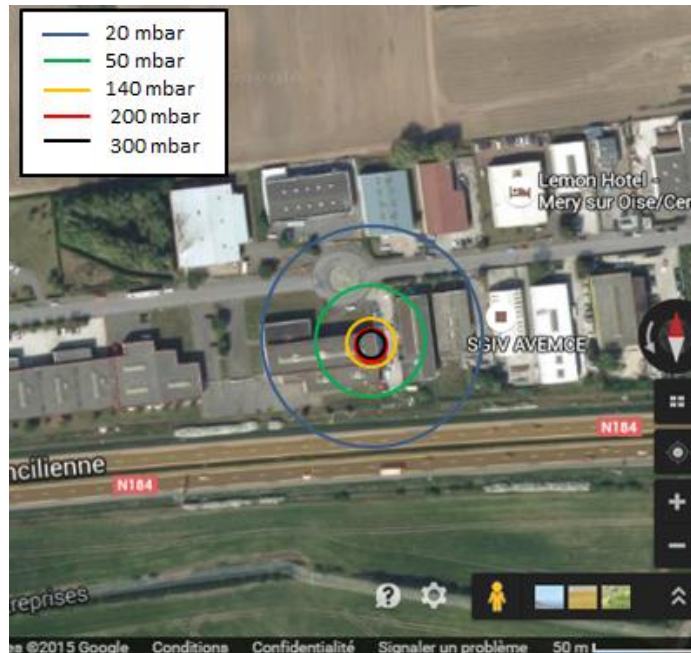
Figure 11 : Représentation cartographique des distances d'effets de surpression de l'explosion d'une bouteille d'azote pour un emplacement donné
