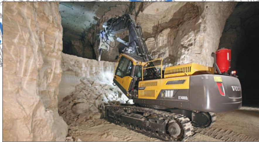
Abattage mécanique du gypse en souterrain au niveau des zones les plus sensibles, si les tirs de mine génèrent des vibrations > 5mm/s (Photo de Vaujours)
