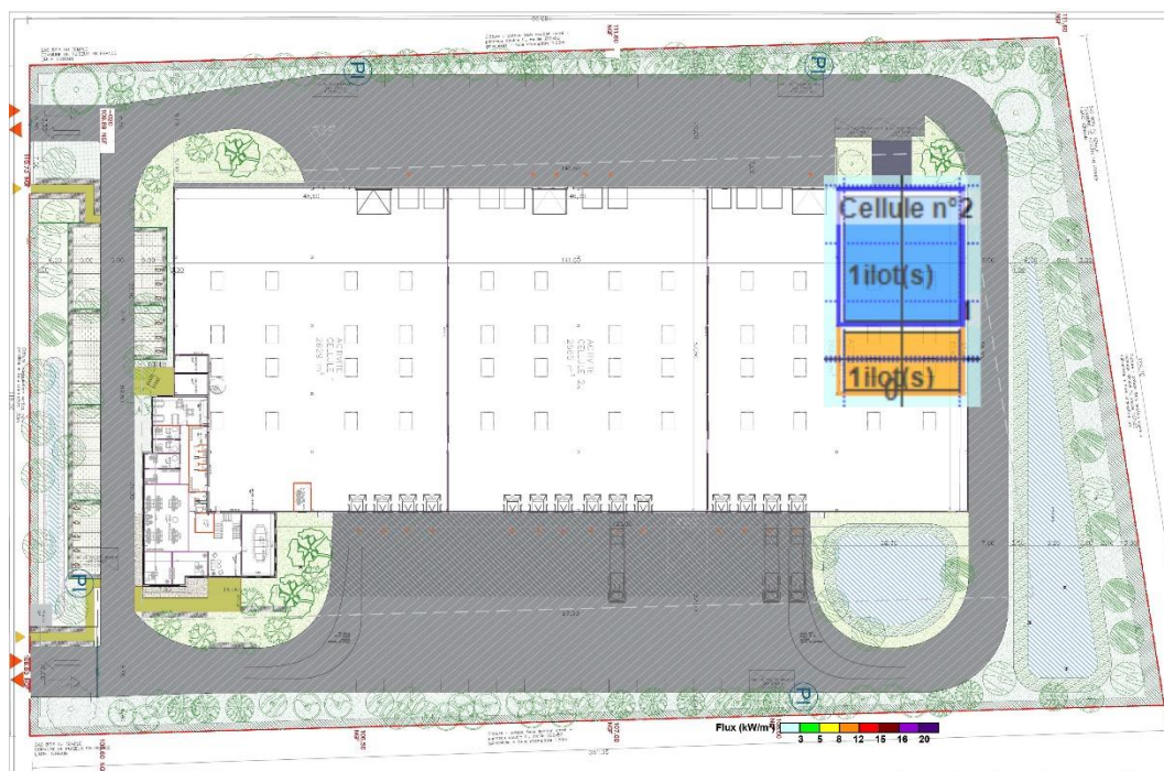
Figure 2. Cartographie des flux thermiques Incendie locaux dédiés à l'atelier bois du Hall C/cellule 3 RDC
