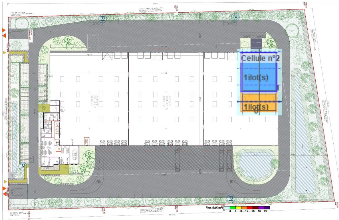
Figure 3. Cartographie des flux thermiques Incendie locaux dédiés à l'atelier bois du Hall C/cellule 3 Etage
